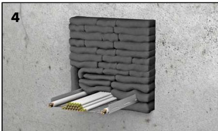
Alla fine della posa dei cuscini la chiusura deve risultare ermetica. E' consentito installare successive linee elettriche passanti senza però oltrepassare il limite del 60% di superficie totale di occupazione rispetto alla superficie dell'apertura (vedere anche specifica a pag. 2).
