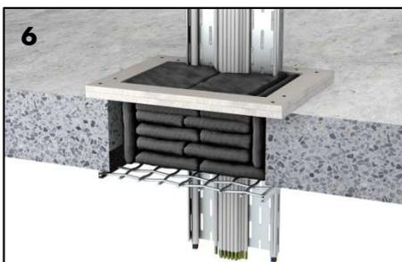
In caso di solai con spessore inferiore a 250 mm deve essere realizzata un'opera di inspessimento del solaio tutt'intorno all'apertura fino ad ottenere lo spessore minimo necessario di 250 mm. L'aumento dello spessore può essere realizzato mediante utilizzo di pannelli in cartongesso, silicato o silicato di calcio di larghezza  $\geq 50$  mm.
